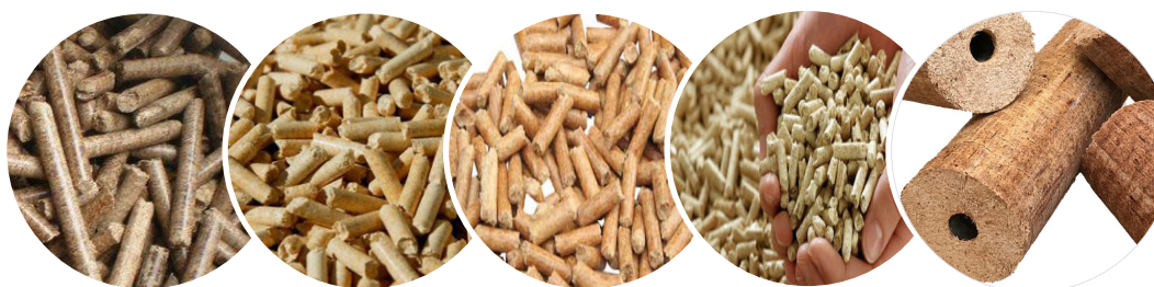
Pellets (<10 mm); pellet briquettes (10–40 mm); briquettes (>40 mm)
