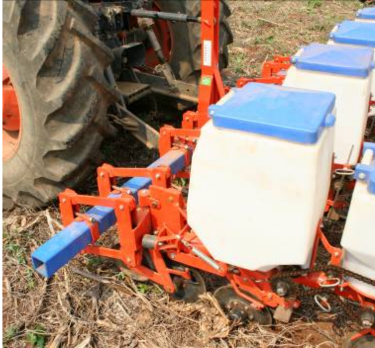
Sowing machine for tractor (Knapik, 4 sowing lines)
